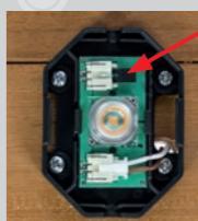
4. Faites passer le câble de connexion de l'éclairage à LED pour bâtiment d'élevage par le bas à travers la fente pour câbles à l'arrière de l'unité de contrôle et connectez-le à l'emplacement prévu pour le module (03 – COOP LIGHTS [Éclairage du poulailler]). Veuillez observer les indications du mode d'emploi de l'unité de contrôle et notamment le chapitre 6.3 Montage et connexion des modules.
