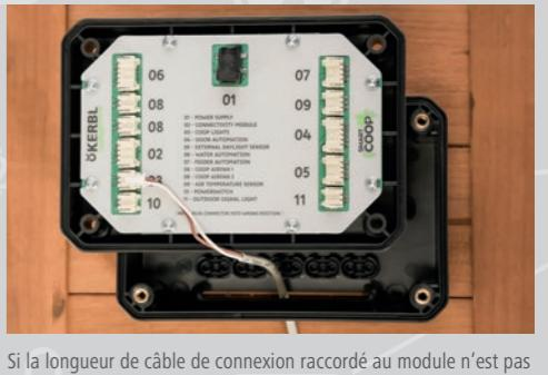
Si la longueur de câble de connexion raccordé au module n'est pas suffisante, servez-vous d'une rallonge (Réf. 70629, 70630). Veuillez à la protection du point de connexion contre l'eau et la poussière ! Un rallongement du câble n'est admissible qu'une seule fois.
