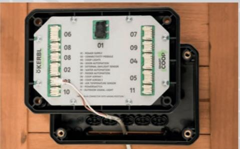
Sollte das am Modul verbaute Anschlusskabel in der Länge nicht ausreichen, so kann es mittels Verlängerungskabel (Art. 70629, 70630) verlängert werden. Achten Sie darauf, dass die Verbindungsstellen vor Wasser und Staub geschützt ist! Das Modulkabel darf max. 1x verlängert werden.
