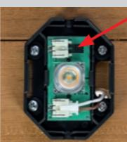
4. Führen Sie das Anschlusskabel der LED Stallbeleuchtung von unten durch den Kabelschlitz des Steuerungsrückteils und schließen Sie es an den vorgesehenen Steckplatz für das Modul (03 – COOP LIGHTS). Bitte beachten Sie die Hinweise in der Betriebsanleitung der Steuerung unter Kapitel 6.3 Montage und Anschluss der Module.
