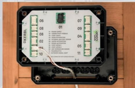
Se la lunghezza del cavo di collegamento installato nel modulo non è sufficiente, il cavo può essere allungato con una prolunga (art. 70629, 70630). Accertarsi che il punto di collegamento sia protetto dall'acqua e dalla polvere! Il cavo del modulo può essere allungato al massimo 1 volta.
