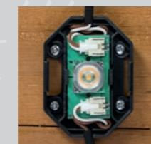
b. Befestigen Sie das 2. Beleuchtungsmodul mittels des im Lieferumfang enthaltenen Befestigungssatzes an der dafür ausgewählten Stelle im Stall. Achten Sie auf eine ausreichende Kabellänge.
